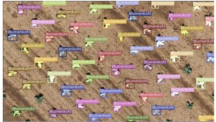
Das mit der Drohne aufgenommene Bild eines Blumenkohlfelds zeigt die mit Hilfe eines Algorithmus erkannten und markierten Pflanzen. © J. Kierdorf
