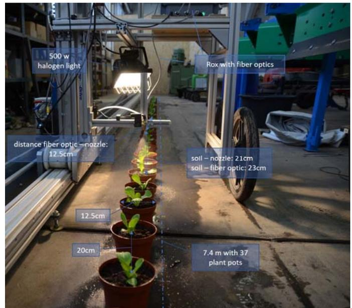
*Der Versuchsaufbau für die Tests mit der Kombination Sensor und Applikationstechnik für Einzelpflanzenbehandlung. Unter dem Link [https://youtu.be/JVoePei\\_5rk](https://youtu.be/JVoePei_5rk) ist eine Aufnahme während der Spritzung zu sehen. © D. Lenzen*
