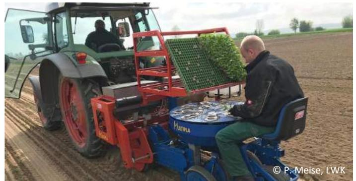
Unterfußdüngestreuer mit angehängter Pflanzmaschine.
